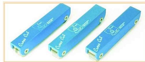
Zestaw noży krążkowych o rozstawie 1 2 i 3 mm
