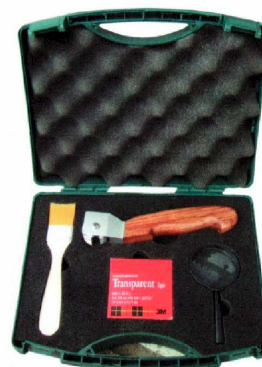
Zestaw noży krążkowych o rozstawie 1 2 i 3 mm
